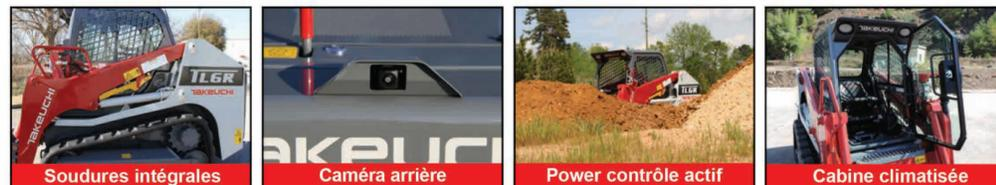
Le TL6R est un concentré de puissance. Avec une force au godet de 26.5 kN couplée à une force de traction de 38.5 kN, ce chargeur compact à chenilles est une machine à la fois performante, puissante et souple.
