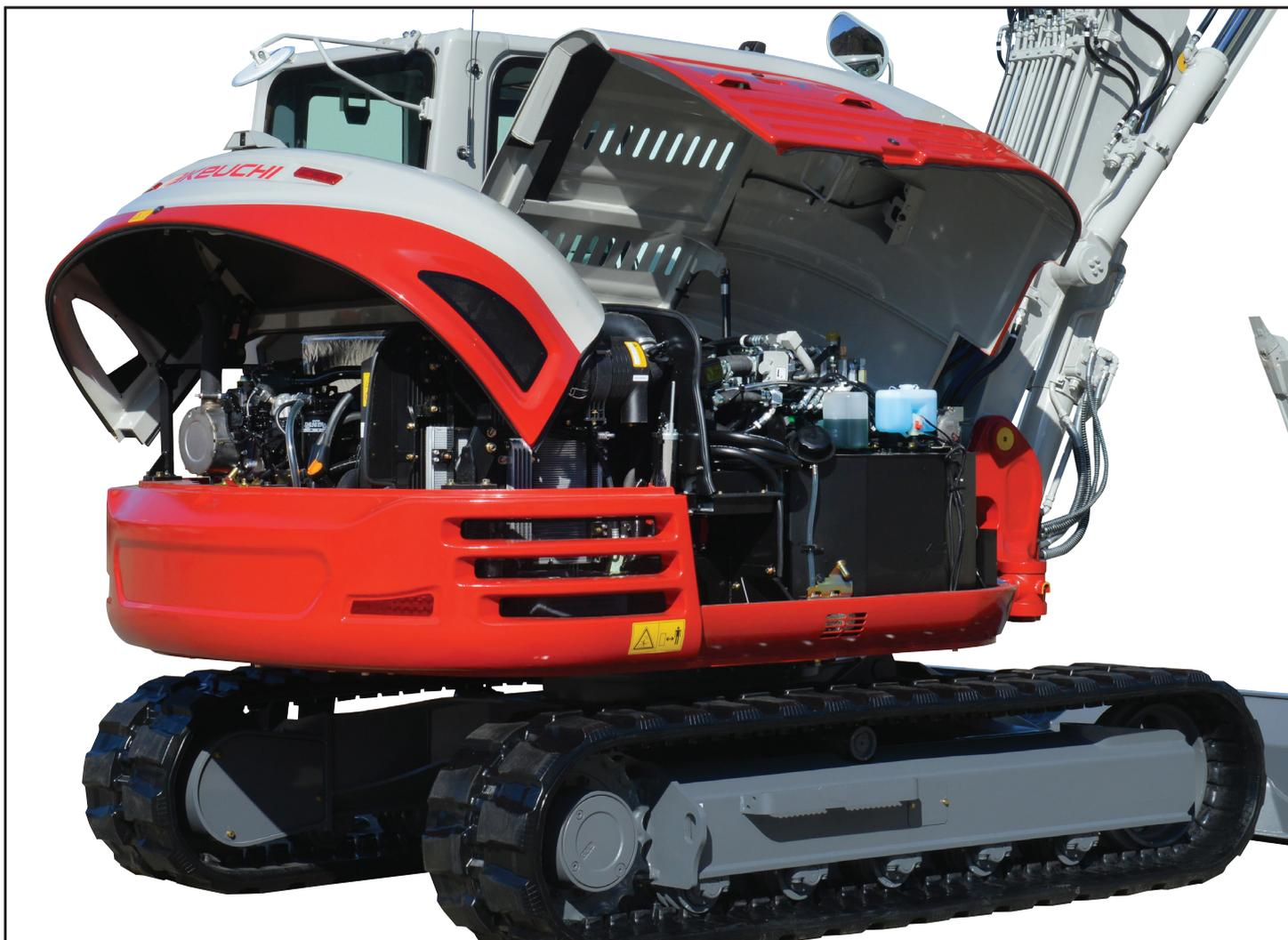
Larges capots acier verrouillables pour une sécurité maximal des composants interne.
