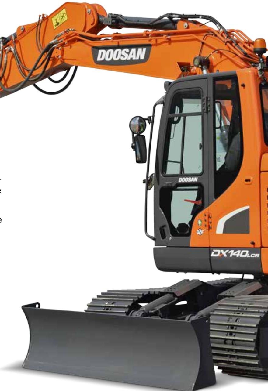
⊙ **Accessoires faciles à utiliser** : réglage du débit et de la pression des circuits hydrauliques auxiliaires directement depuis l'écran de contrôle. En outre, 10 pré-sélections sont disponibles pour enregistrer des réglages spécifiques.
