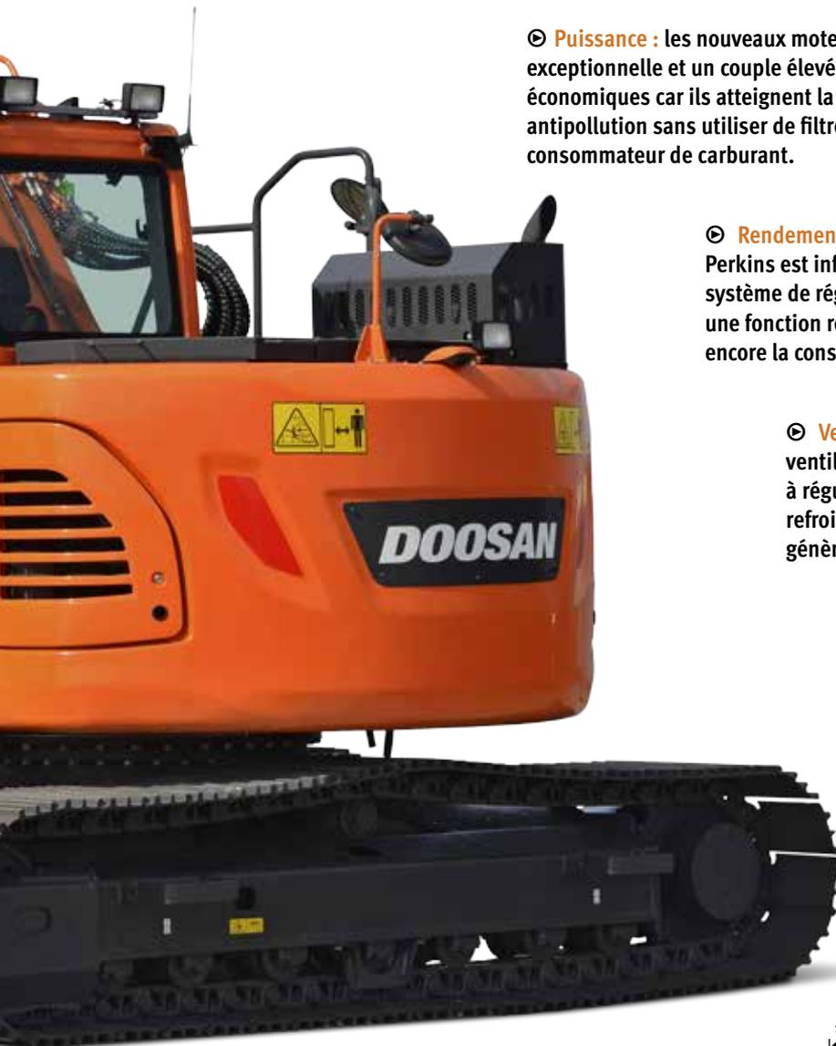
☉ **Châssis inférieur particulièrement durable** : galets supérieurs en acier forgé durci en profondeur, galets inférieurs à bain d'huile, barbotins en acier trempé, maillons de chenille en acier trempé durci en profondeur, axes étanches et graissés à vie.
